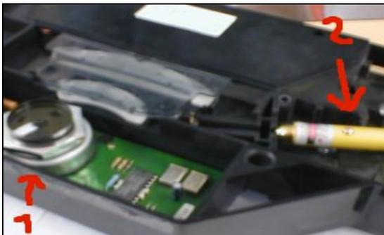
Fig 4: Voici notre maquette. A gauche nous pouvons voir le miroir polygonal (1). Nous avons remplacé le laser par un « laser de poche » (2) pour que tout le monde puisse voir le point lumineux.
