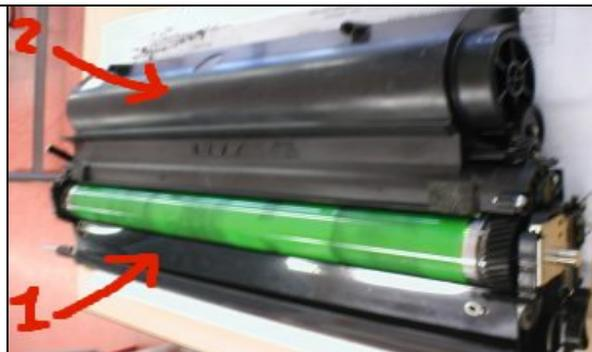
Fig 5: L'imprimante démontée. Le « tube vert » (1) est en fait le tambour opc en selenium. Ce que vous voyez au-dessus du tambour opc est la réserve d'encre en poudre (le toner ; 2).
